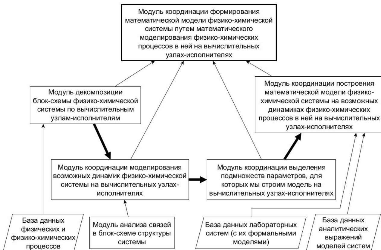
Рисунок 30 – Модуль координации формирования математической модели заданной физико-химической системы на вычислительных узлах-исполнителях. Толстыми стрелками показана последовательность выхода библиотек в процессе построения модели системы. Тонкими стрелками – какие модули расширения положены в основу каких модулей расширения
