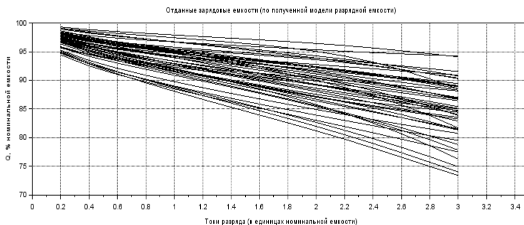
Рисунок 149 – Кривые разрядных емкостей литий-ионного аккумулятора серии US18650VTC6 в зависимости от разрядных токов, полученные из полученной аналитической модели разрядных емкостей
