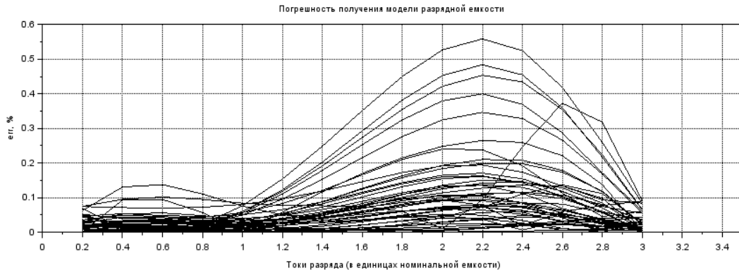
Рисунок 150 – Погрешности получения аналитической модели разрядных емкостей литий-ионного аккумулятора серии US18650VTC6 из модели динамики физико-химических процессов в этом аккумуляторе
